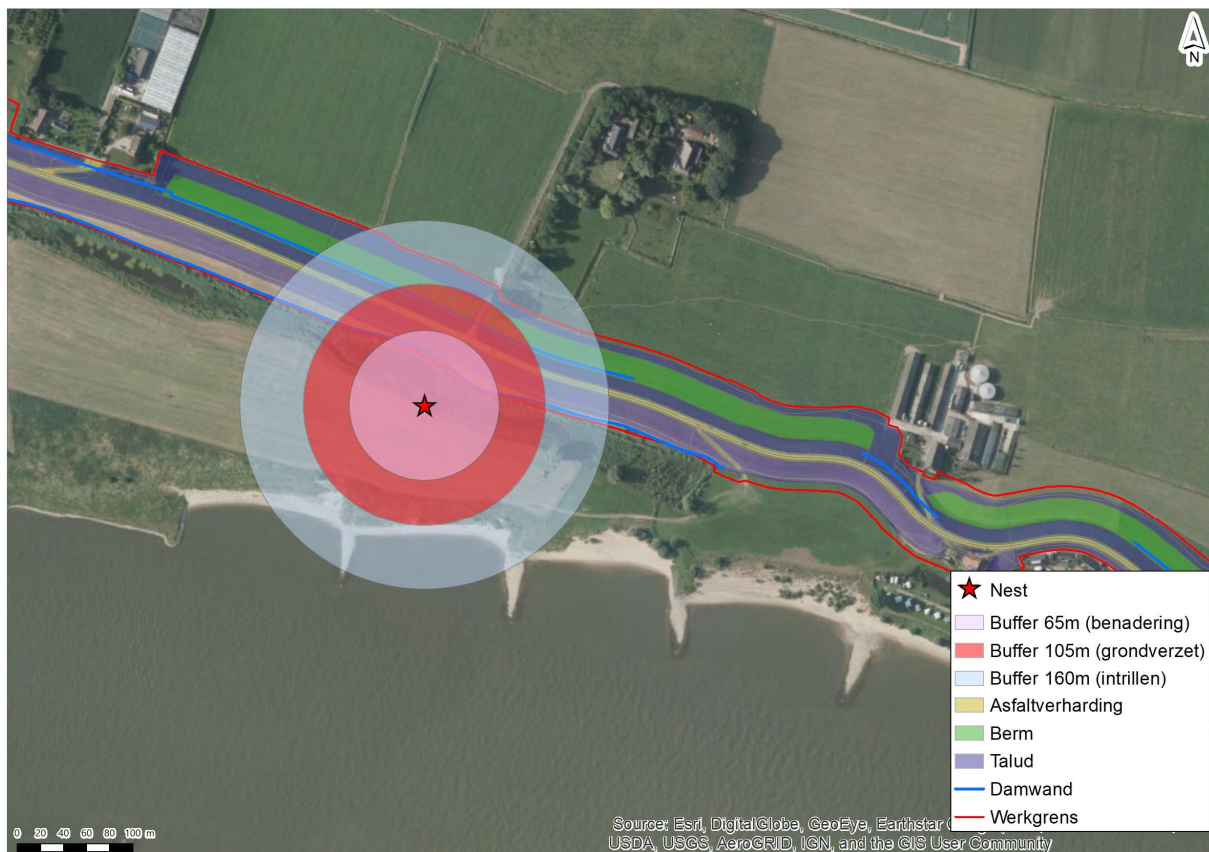
Afbeelding 5.74 Mitigerende maatregelen voor het nest van buizerd in dijksectie 13 bij intrillen damwand
