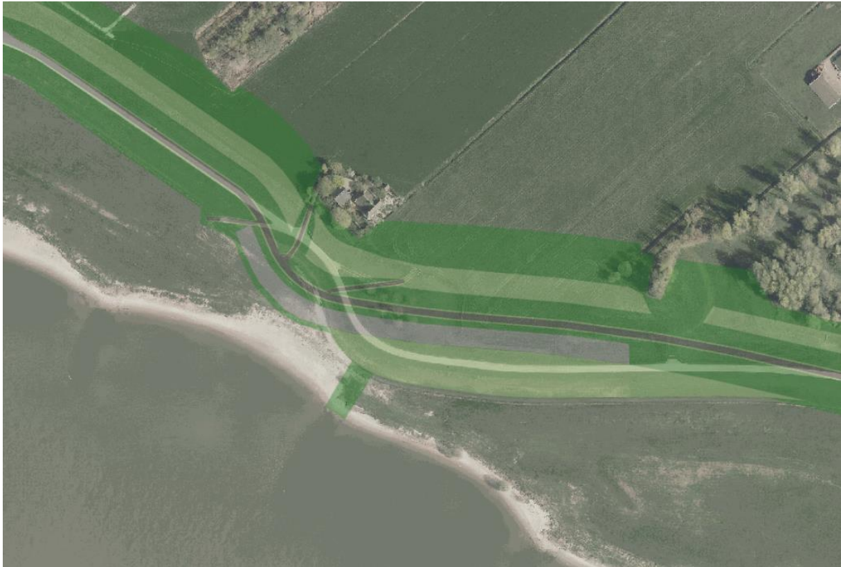
Afbeelding 5.6 Verlegging van op- en afritten bij dijksectie 17
