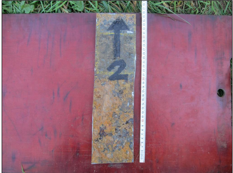
Foto 19: Genomen staalcoupon locatie 2.
