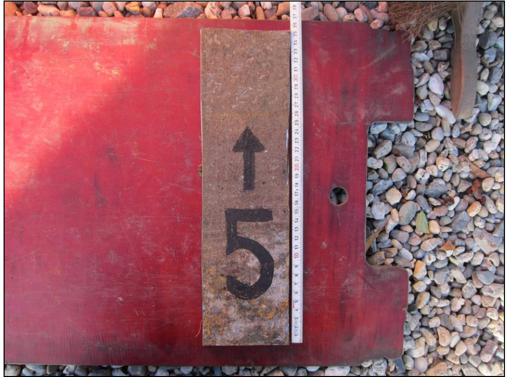
Foto 43: Genomen staalcoupon locatie 5.
