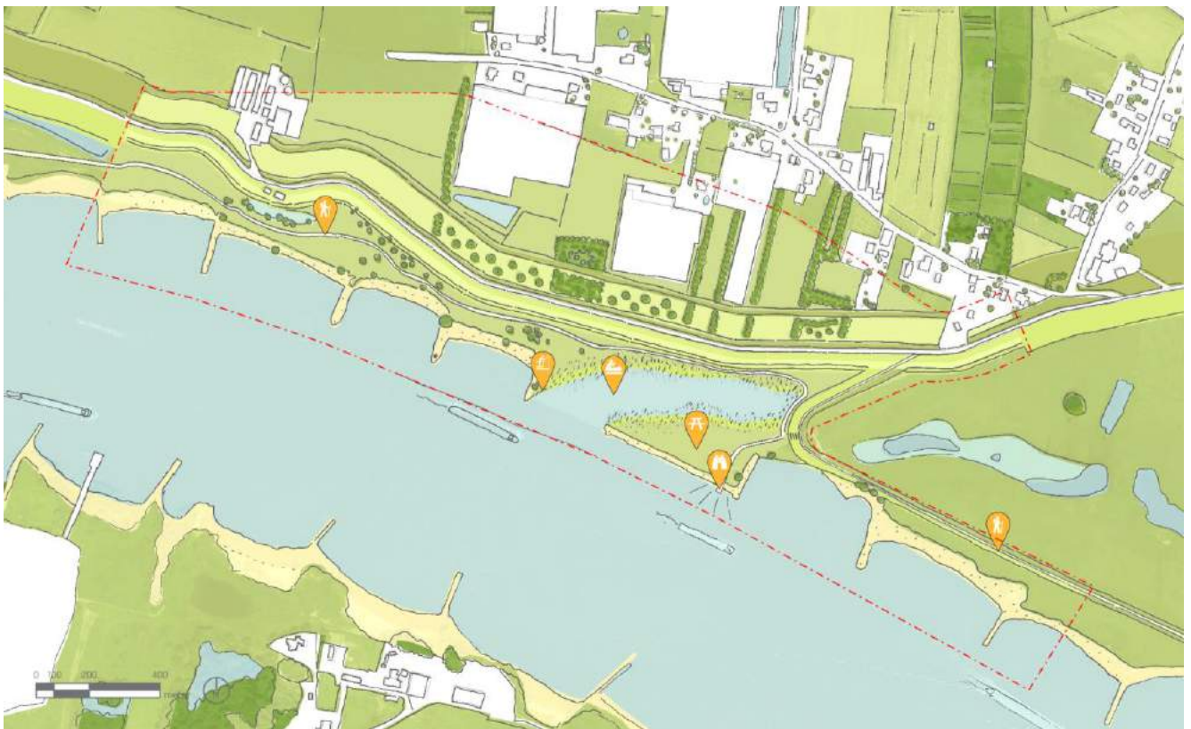
Afbeelding 3.15 Alternatief 1 voor dijkteruglegging: beperkte verlegging
