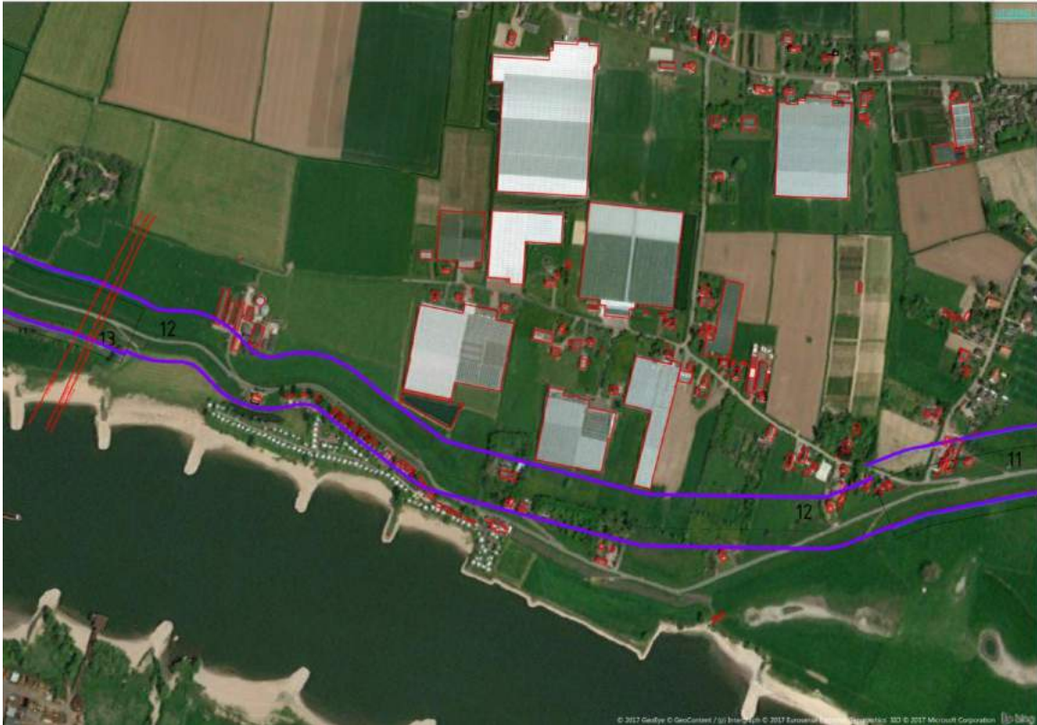
Afbeelding 3.8 Tracéalternatief 2: De dijk tot de grens met de glastuinbouw terugleggen (maximaal circa 100 m)
